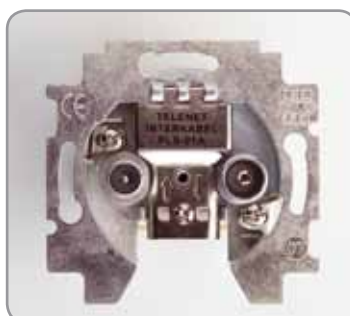
Wandcontactdozen ingebouwd: gebruik dan vierkante of ronde inbouwdoosjes met zijdelingse schroefbevestiging.
